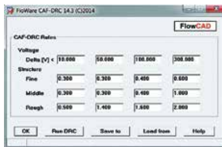
Bild 5: DRC-Matrix für Spannungsklasse, Glas-Struktur und Mindestabstand. Das FloWare-Modul CAF-DRC ist auf Wunsch und Spezifikation von Anwendern in Deutschland innerhalb von wenigen Tagen entstanden. Verfügbar ist das Modul bei FlowCAD oder im App-Store auf dem OrCAD Marketplace.
